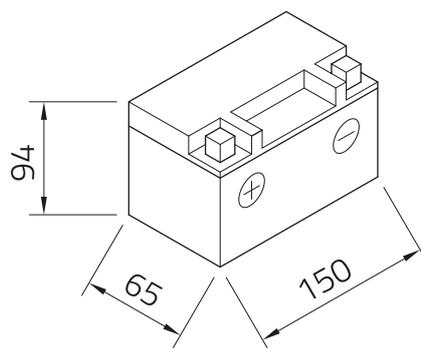
Technologie Verschlossene AGM (Elektrolyt in Glasfaser-Vlies gebunden) | gefüllt und geladen | absolut wartungsfrei
